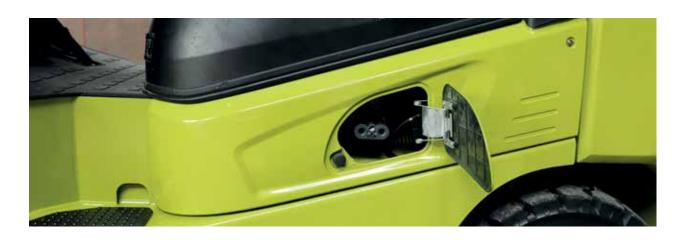
Das Nachladen der Li-Ion-Batterie ist bequem über eine seitlich zu öffnende Klappe möglich, ohne die Batterieabdeckung öffnen zu müssen.
